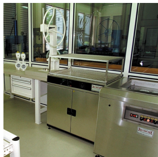
Assemblaggio, collaudo e imballaggio in camera bianca classe 10'000 / ISO classe 7
